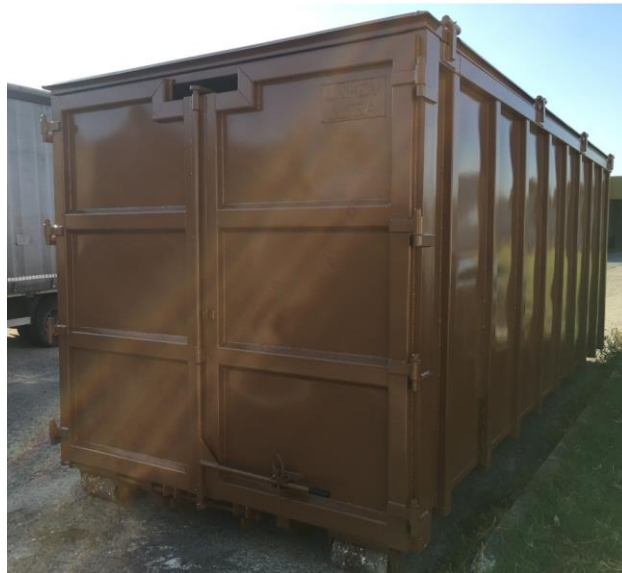
Ab-roll kontajner, uzatvorený, tesniaci, objem 35 m 3
