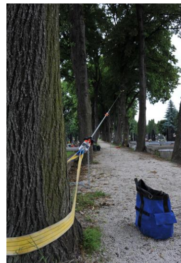
Kotvenie o strom (2. smer ťahu)
